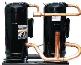
Fabricados por empresas reconocidas mundialmente, que respaldan la calidad y eficiencia del producto. En todos los equipos se usan compresores Scroll, todos son trifásicos y llevan resistencia de cárter. Los modelos 40, 50, y 60 están equipados con 4 compresores y 2 circuitos. Los compresores son gestionados por el controlador c.pCOEM. Para unidades con otro tipo de compresores, es necesario consultar con la fábrica.
