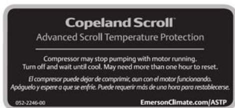
Etiqueta que identifica a los compresores con dispositivo ASTP
