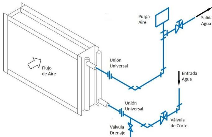
Fig.6 – Ubicación de algunos componentes de conexión en un serpentín con flujo de aire horizontal.
